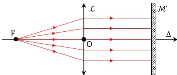
Propagation des rayons lumineux avant réflexion sur  $\mathcal{M}$
